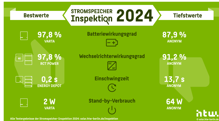
Bild 3 Bandbreite der Labortestergebnisse in der Stromspeicher-Inspektion 2024 auf Basis des Vergleichs von 20 Solarstromspeichern.
